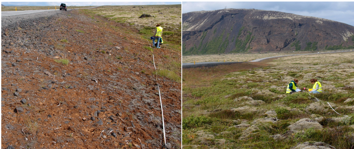
Mynd 5. Mælingar á gróðurfari vegfláa þar sem svarðlag hafði verið notað við uppgræðslu (vinstri) og grenndargróðurs á Lyngdalsheiði (hægri) í ágúst 2017.
